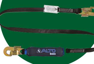
Línea o cuerda flexible que sirve para asegurar el arnés a un punto de anclaje mediante ganchos de seguridad en los extremos. compuesto por 2 ganchos de doble seguro que evitan una liberación accidental, y cuentan con una apertura de 3/4" (19mm). El cuerpo del cable es de Poliéster, cuenta con un amortiguador de impacto, que absorbe la energía en un evento de caída.
