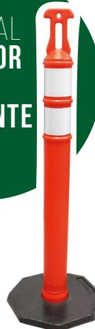
Fabricado en polietileno alta densidad color naranja con protección a rayos UV. Resistente a la intemperie, reflejante grado ingeniería (puede ser sin reflejante). Altura 1.20m, diámetro 10 cm, base octagonal de caucho reciclado, con diámetro de 40 cm. Peso de 5 kg, altura 4cm. En parte superior se puede colocar lámpara de destello, cinta delimitadora, cadena plástica o malla delimitadora.
