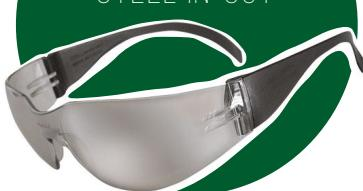
Lente de policarbonato, con tratamiento antiempañamiento y patillas tipo espátula, puente nasal universal, diseño ergonómico, filtro UV, cuenta con tratamiento antirayaduras.
